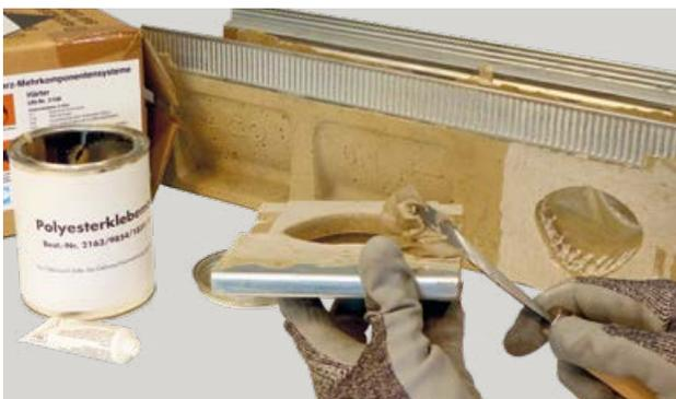
Für das Verkleben sollte die Polyesterklebemasse mit dem richtigen Mischungsverhältnis des Härters vermischt, auf die Klebeflächen aufgebracht und schlussendlich beide Teile miteinander verklebt werden (siehe beiliegende Anleitung)
