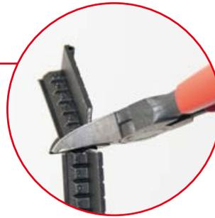
bei Bedarf mit Seitenschneider kürzen
