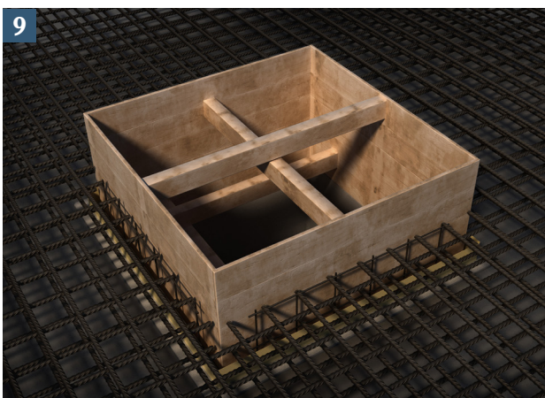
9 Anschluss zur Bewehrung des Pumpensumpfes herstellen. Betonüberdeckung beachten! Betonieren. Kontakt der Rüttelflasche mit der Schalung vermeiden, da diese verrutschen und undicht werden kann.
