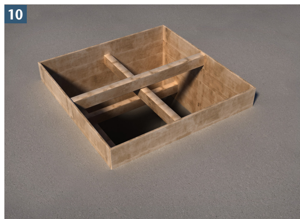
10 Die passende Schachtabdeckung wird in die oberste Lage (Estrich) eingearbeitet.
