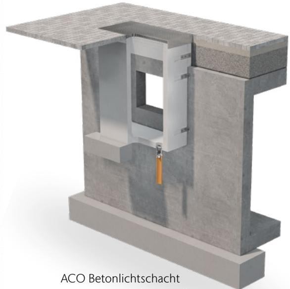
ACO Betonlichtschacht druckwasserdicht an Kellerwand montiert in Lkw-befahrbarer Ausführung mit angeschraubter Hinterfüllplatte, die Hinterfüllplatte ist in diesem Fall nicht druckwasserdicht angebunden
