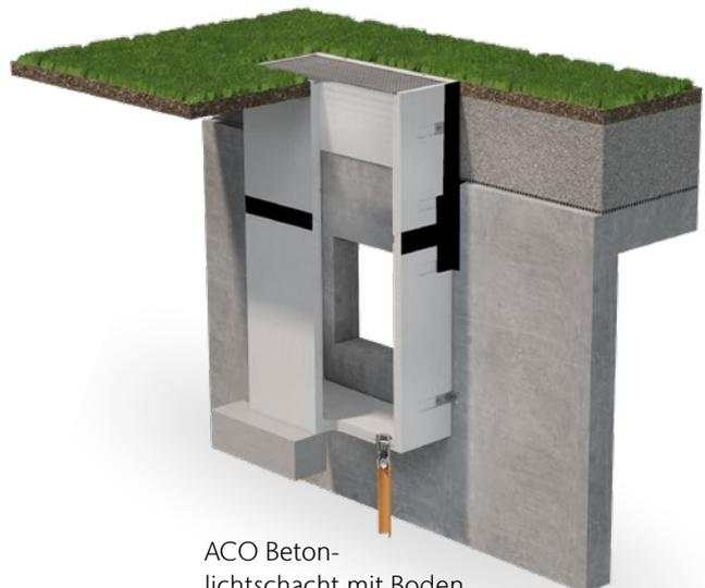
ACO Betonlichtschacht mit Boden druckwasserdicht mit ACO Dichtfix montiert, Betonlichtschacht ohne Boden und mit angeschraubter Hinterfüllplatte aufgestapelt und bauseits angeichtet
