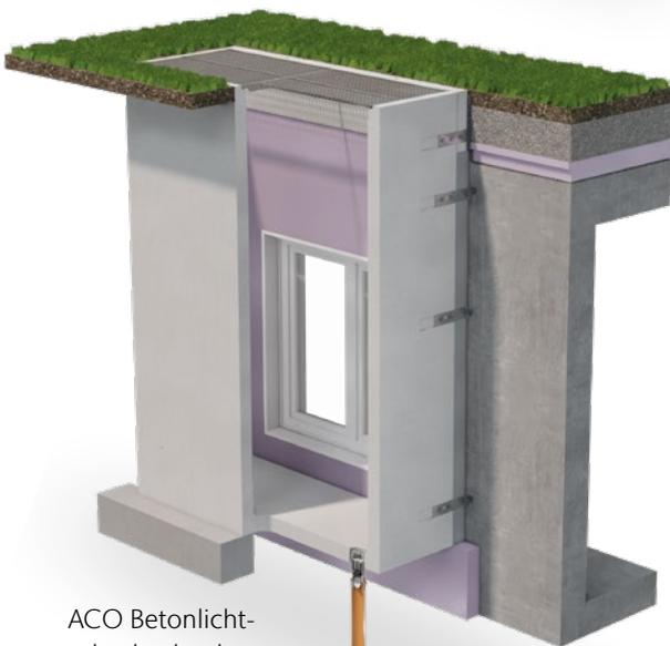
ACO Betonlichtschacht druckwasserdicht auf Dämmung montiert mit angeschraubter Hinterfüllplatte. Die Hinterfüllplatte ist in diesem Fall nicht druckwasserdicht angebunden
