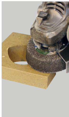
Anschleifen der Klebeflächen
