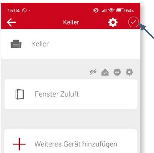
Wählen Sie das Gerät aus und gehen Sie über das Bedienungsmenü oben rechts in die Geräteeinstellungen.
