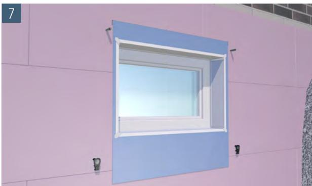
7 Kleben Sie die Rückwand an. Orientieren Sie sich an den zuvor gesetzten Markierungen und der Fensterausparung
