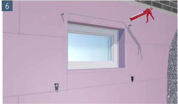
6 Nehmen Sie den Lichtschacht von der Wand. Bringen sie an der Oberkante der Rückwand und rund um die Fensterausparung den Klebedichtstoff auf
