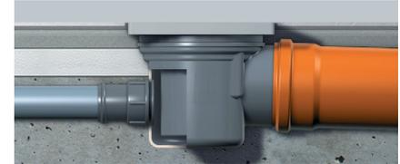
Bei Bedarf können über ein Verlängerungsstück tiefere Bodenaufbauten realisiert werden. Weiterhin lässt sich bauseits problemlos ein Zulauf DN 50 anbringen, dazu muss mit einer Sägeglocke eine Bohrung mit einem lichten Maß von 60 mm hergestellt werden.
