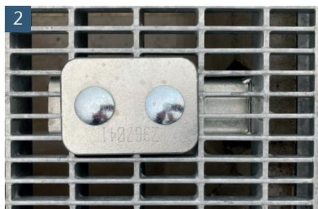
Legen Sie die 4 Konterplatten auf dem Rost auf und setzen Sie die Schlossschrauben in die vorgesehenen Bohrungen der Konterplatte und Anschraubkonsole ein
