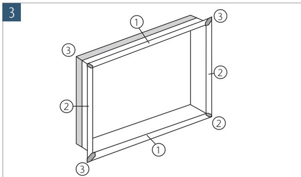
Nach dem Zusammenstecken der Anschlussprofile 1 + 2 und der Eckverbinder 3 ist die Dichtung aus dem Therm Leibungskellerfenster zu entfernen.
