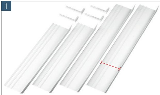
4-teiliges Dämmungsanschlussprofil mit Eckverbindern (für Perimeterdämmung 0 – ca. 140 mm bzw. 0 – ca. 200 mm). Das Dämmungsanschlussprofil ist leicht auf die vor Ort benötigten Dämmstärken anpassbar. Es muss 5 mm bis 10 mm in die Nut eingearbeitet werden.
