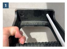
Steigeisen positionieren und Befestigungspunkte anzeichnen.
