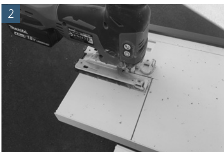
Ausklinkung mit Stichsäge vornehmen
