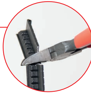
bei Bedarf mit Seitenschneider kürzen
