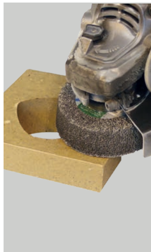
Anschleifen der Klebeflächen
