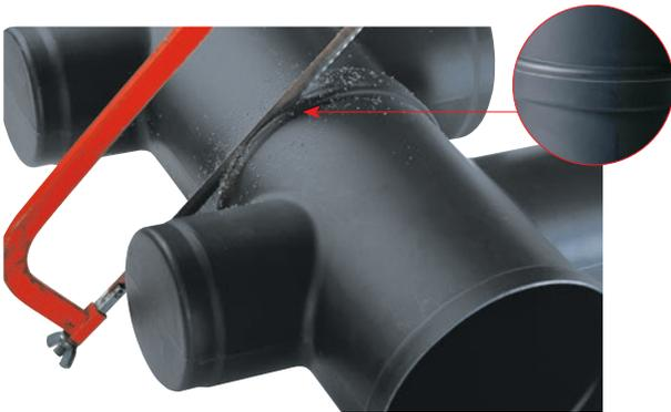
Zum Ablängen des Ablaufschachts zunächst Schmutzfangeimer, Ablaufadapter sowie Dichtung entfernen. Anschließend den Ablaufkörper an der gekennzeichneten Schnittlinie trennen. Dichtung und Ablaufadapter auf die Schnittkante des verkürzten Schachts aufsetzen
