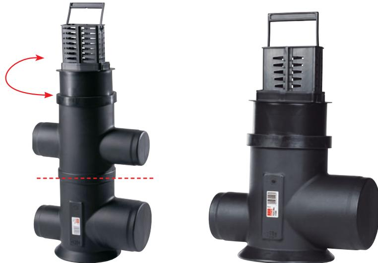
Ablaufschacht mit Schmutzfangeimer und Ablaufadapter zum Anschließen senkrecht unterhalb der Rinne. Die runde Form ermöglicht ein einfaches Ausrichten nach der Grundleitung. Seitliche Abgänge DN/OD 110 und DN/OD 150
