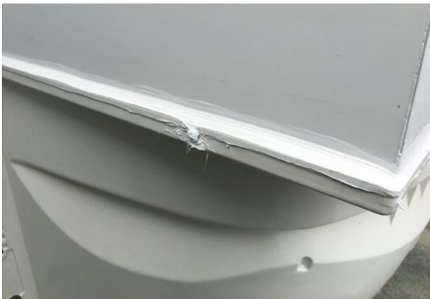
14. Streichen Sie nun das überschüssige Dichtungsmaterial rundherum ab und überstreichen die Schrauben zusätzlich mit Dichtstoff
